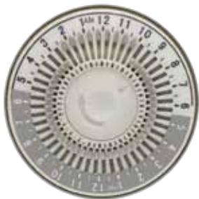
Figure 1 - illustre le réglage de la minuterie pour mettre en marche l'appareil à 22 h (10 PM) et l'arrêter à 2 h (2 AM). Remarquez que TOUS les segments entre 10 PM et 2 AM ont été réglés. L'heure actuelle est 20 h (8:00 PM).
